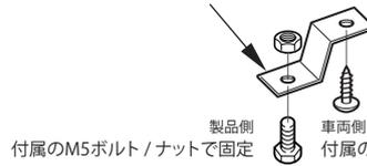
製品側 付属のM5ボルト/ナットで固定
