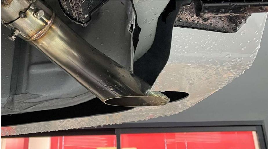
※リアバンパーより上側に取り付けた場合リアバンパーが排気熱で焼ける恐れがあるので注意してください。
