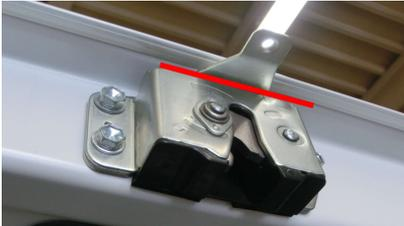
※写真の赤ライン部を切断する。
