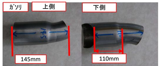
※マフラー先端部の上側と下側を写真の寸法の位置にて切
