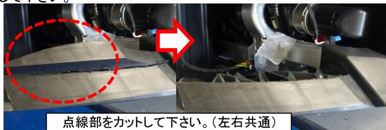
【7】車両側コンデンサーシュラウドの一部をカットして下さい。
