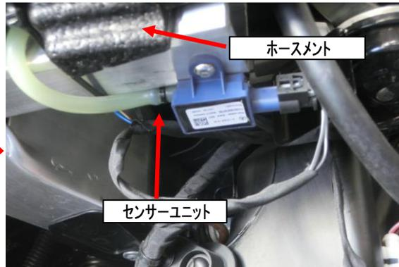
【4】純正バンパーよりフロントグリル及びグリル上部のインナーパーツ、エンブレム及びPTSセンサー付き車両はセンサーを取外し、移設して下さい。PTSセンサーはコーキングボンド(別売)等で製品に確実に固定して下さい。
