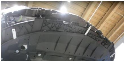
【11】サイドリテーナーを車両側に取付け、下面にアンダーカバーと付属のボタンヘッドボルト(M5×15)とフランジナット(M5)で固定できる様に穴をあけ、固定して下さい。
