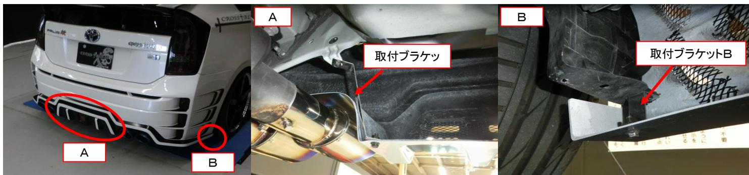
※各取付ブラケットは、付属のフランジボルト(M6×16)とフランジナット(M6)にて取付けてください。
